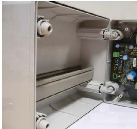
*Figura 28. Canaleta estrecha instalada en remota Neptuno*
